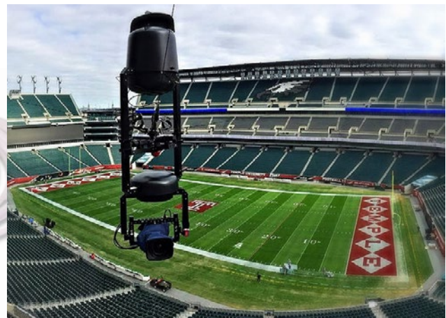
KAMERASYSTEM DER FA. SPIDERCAM MIT SPINNER 1.14L OPTISCHER DREHKUPPLUNG UND KOMPAKTEM SCHLEIFRING
